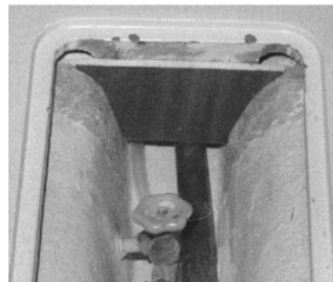
Fig 2. Förstärkning av 10 mm marinplywood inpassad dikt mot aktre kölrúmmets "skott" och mot skrovet.
