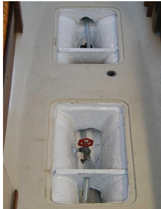
Bild 4. Underst den aktre förstärkningen, i borte kanten på samma ficka den tidigare installerade förstärkningen, samt i övre fickan den främre förstärkningen.
